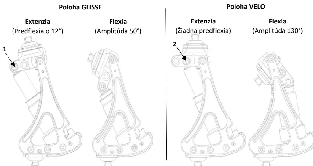
**⚠️** Utiahnutie a uvoľnenie skrutiek sa vykonáva dynamometrickým kľúčom vybaveným nástavcom Torx T30.
