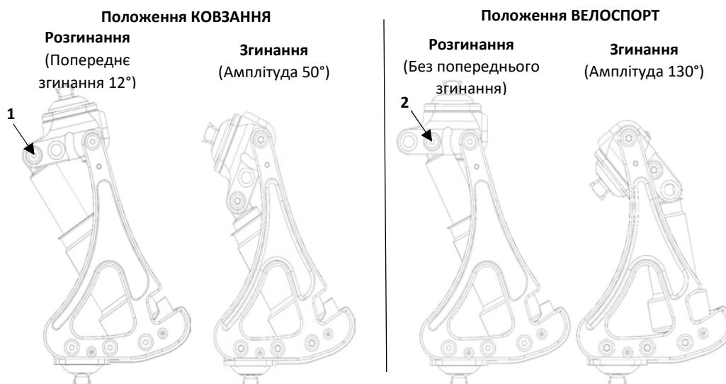
**⚠️** Затягування і ослаблення гвинтів повинно виконуватися за допомогою динамометричного ключа з битою Torx T30.
