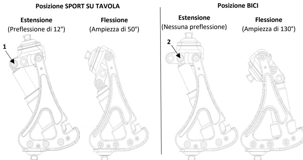
**⚠️** Il serraggio e il disserraggio delle viti deve essere effettuato con una chiave dinamometrica dotata di un attacco Torx T30.
