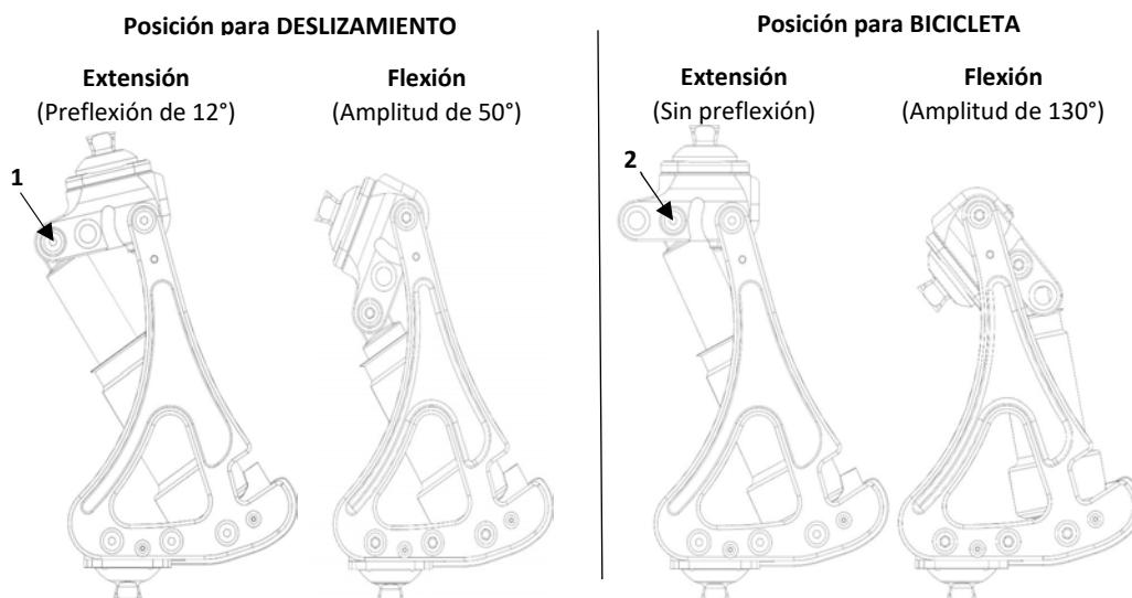
**⚠️** Los tornillos deben apretarse y aflojarse usando una llave dinamométrica provista de un conector Torx T30.
