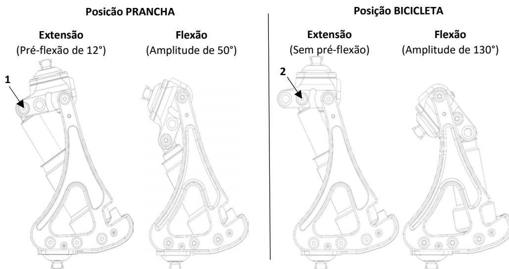
**⚠️** Deverá apertar e desapertar os parafusos com uma chave dinamométrica com uma ponta Torx T30.
